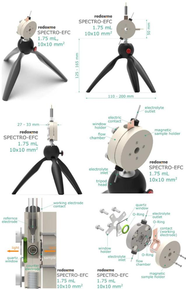
分光電気化学セルは吸光度/透過率と電気化学ポテンシャルの関係を研究するために使用されます。エレクトロクロミック材料の光学的変化をリアルタイムに記録します。in situ(その場)でスペクトルを得ることができます。電気化学的に生成された短寿命種/中間体の検出および特性評価、酸化還元プロセスの機構的経路の詳細な研究に適しています。作用電極からの銅の電気接点は、電解質と接触しないことにご注意ください。
